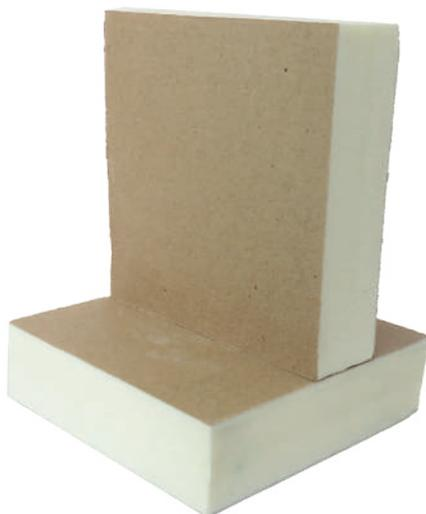
Láminas rígidas fabricadas con poliuretano expandido auto extinguido revestidos en ambas caras con papel Kraft o sin revestimiento, con una densidad de 40 kg/m<sup>3</sup>, ampliamente utilizadas para el aislamiento de pisos en almacenes frigoríficos, habitaciones ambientales, cavas, salas limpias e instalaciones de procesamiento y conservación de alimentos.
